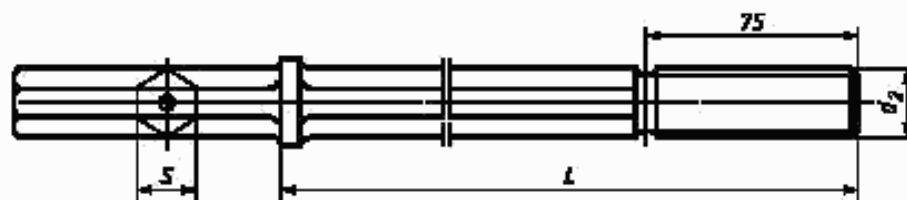
Рисунок 4 — Буровые штанги с резьбой
