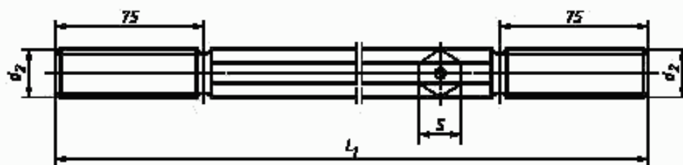
Рисунок 5 — Буровые и удлинительные штанги с резьбой
