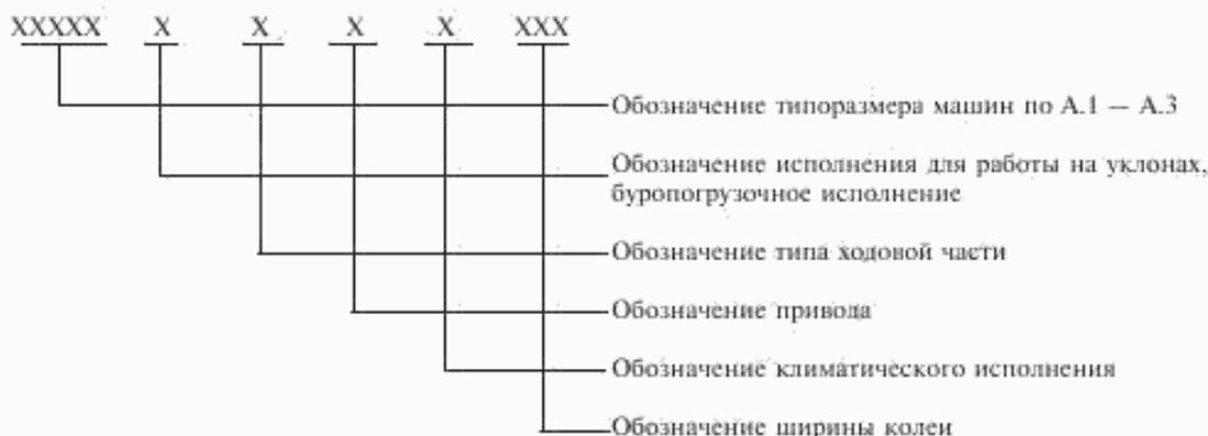
**А.6 Пример условного обозначения базовой модели машины типа 1 с технической производительностью 1,25 м<sup>3</sup>/мин, ступенчатой погрузки, с рельсовой ходовой частью и шириной колеи 900 мм, электрическим приводом, для районов с умеренным климатом.**
