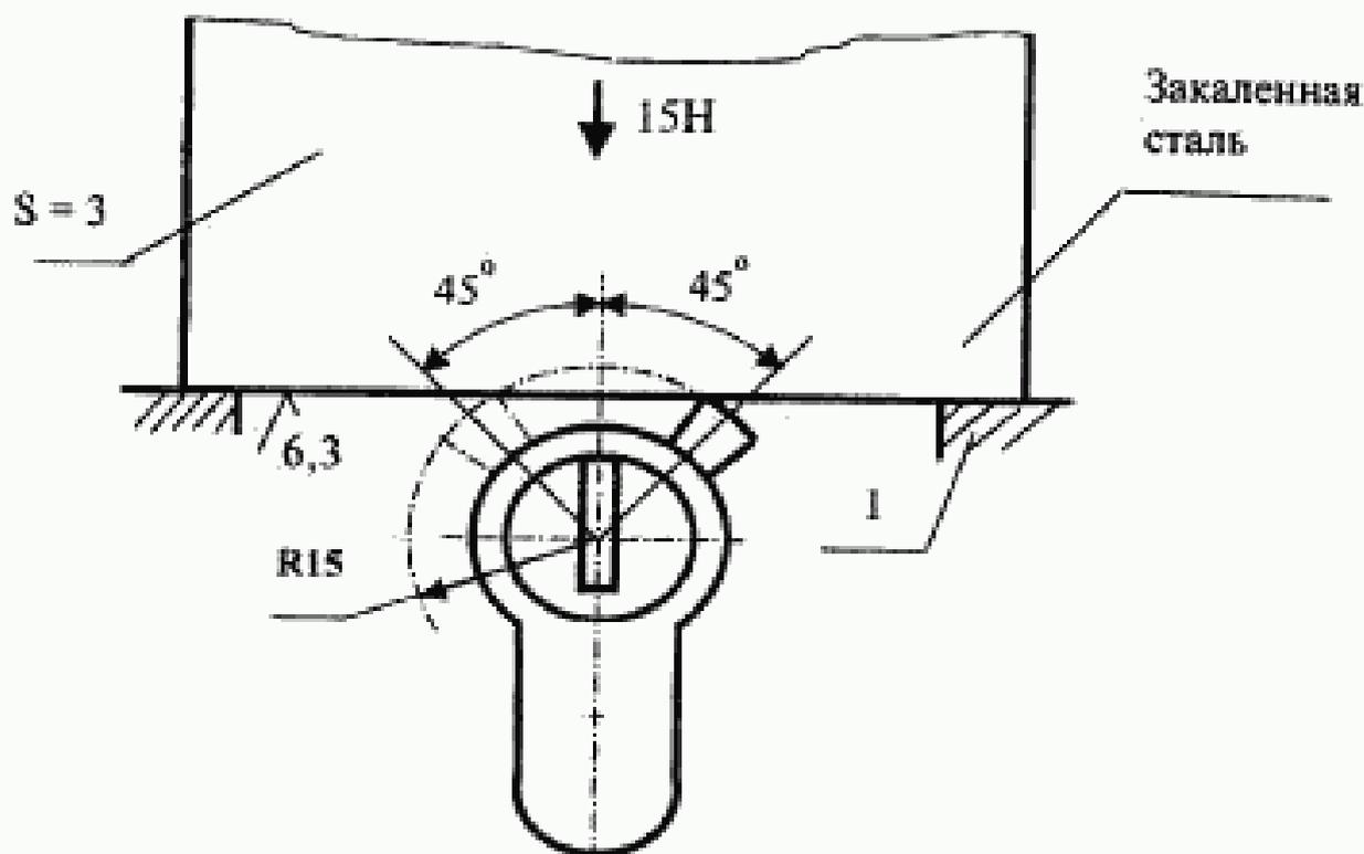
Рисунок 1 — Схема испытания цилиндрического механизма на наработку
