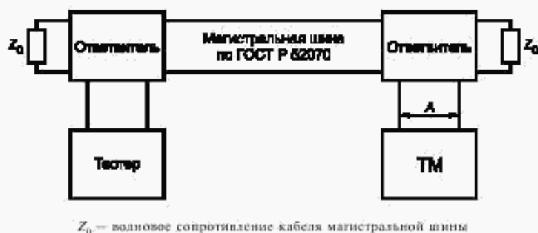
Рисунок 2 — Общая схема тестирования ТМ с использованием физической магистрали
