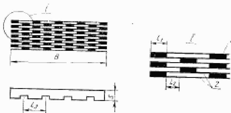
$B$ —ширина;  $S$ —толщина;  $L_1$ —ширина клеевых полос;  $L_2$ —расстояние между смежными клеевыми полосами;  $L_3$ —расстояние между прорезями; 1—клеевой шов; 2—листы бумаги
