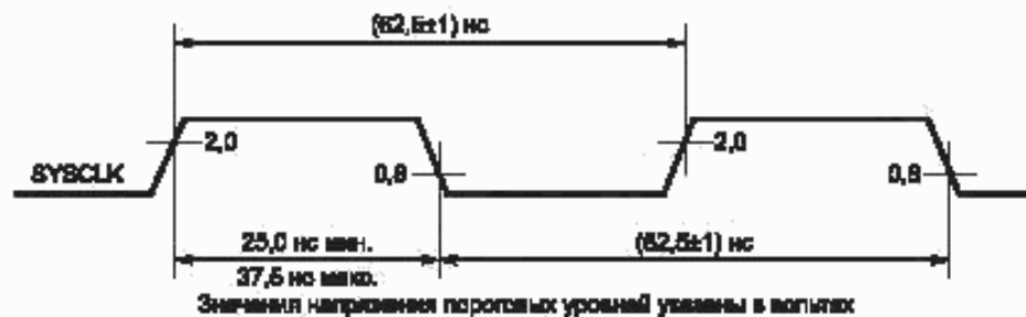
Рисунок 5.2 — Временная диаграмма работы формирователя системного тактового сигнала
