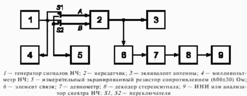
Рисунок 14 — Схема измерения коэффициента гармоник передатчика в режиме «Стерео»
