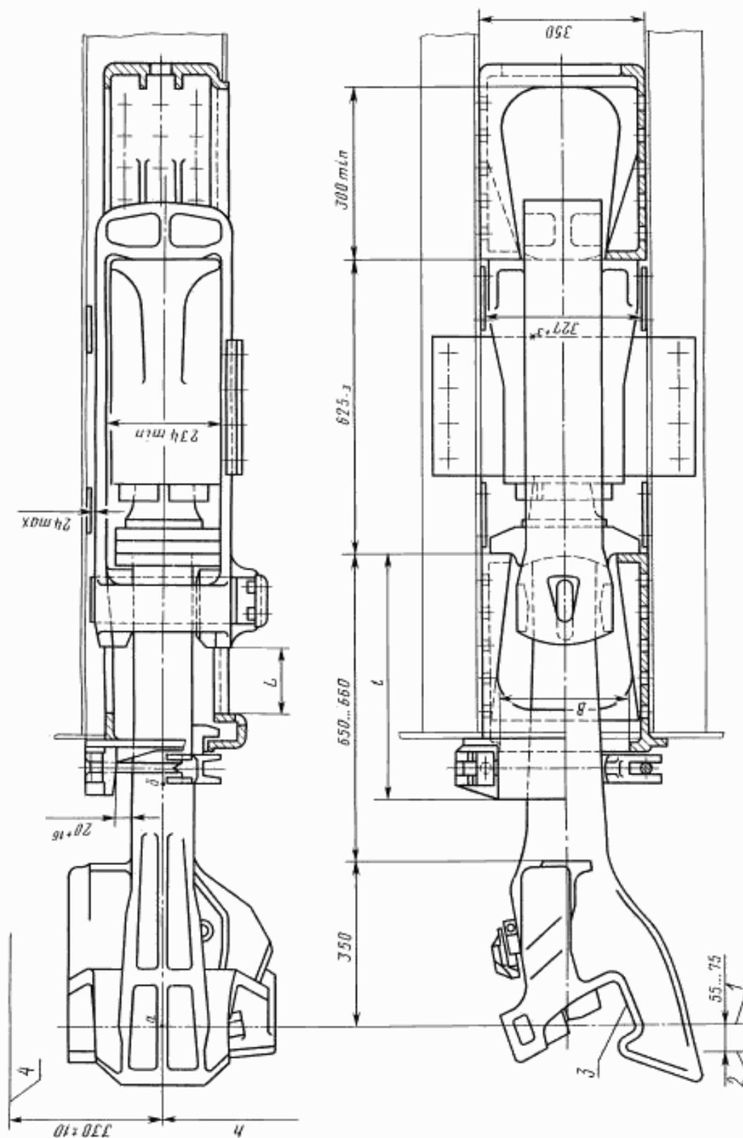
1 — плоскость зацепления автосцепки; 2 — упорная поверхность буферов пассажирских вагонов; 3 — контур зацепления автосцепки по ГОСТ 21447; 4 — линия приближения к автосцепке переходной площадки пассажирских вагонов
