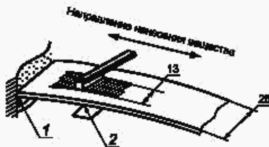
Рисунок 24 — Способ нанесения химических веществ на образец для испытаний
