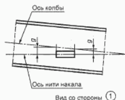
Рисунок 6 — Эксцентриситет оси колбы 10)
