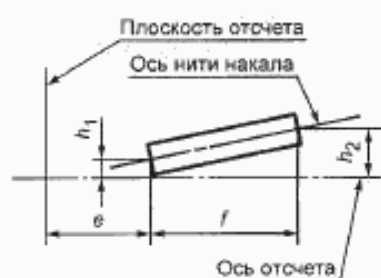
Рисунок 5 — Допустимое смещение оси нити накала 9) (только для эталонных ламп накаливания)
