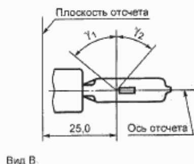
Рисунок 3 — Зона без оптического искажения *)
