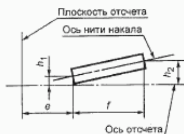
Рисунок 5 — Смещение нити накала *) (только для эталонных ламп накаливания)
