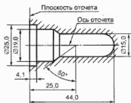
Рисунок 2 — Максимальные размеры лампы 1)
