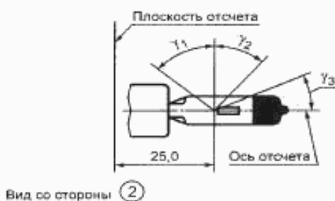
Рисунок 3 — Зона отсутствия искажения 6) и черная верхняя часть 7)
