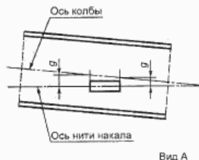
Рисунок 6 — Эксцентриситет оси колбы *)
