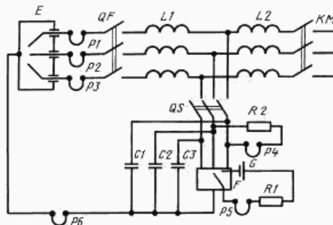
*E* — экспериментальная установка; *QF* — автоматический выключатель; *QS* — автоматический выключатель; *L1*, *L2* — кабельные вставки; *KM* — магнитный пускатель; *P1*—*P6* — вибраторы; *G* — источник питания; *R1*, *R2* и *R3* — сопротивления; *C1*, *C2*, *C3* — емкости; *F* — аппарат защиты
