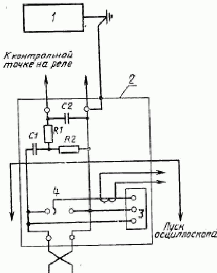
Источник напряжения постоянного тока с высоким выходным сопротивлением
