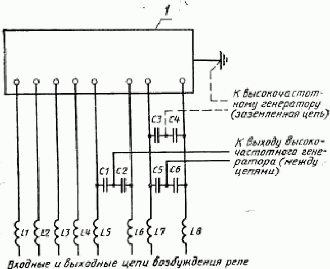
1 — корпус реле;  $C1=C2=C3=C4=C5=C6=0,5$  мкФ;  $L1=L2=L3=L4=L5=L6=L7=L8=(1-5)$  мГн
