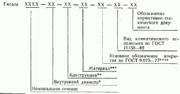
Для ответвительных гильз указывают внутренние дваметры для основного кабеля или провода и ответвляемого.
