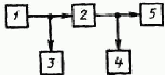
1 — низкочастотный генератор сигналов; 2 — измеряемый тракт или звено; 3 — вольтметр; 4 — измеритель нелинейных искажений; 5 — номинальное сопротивление нагрузки
