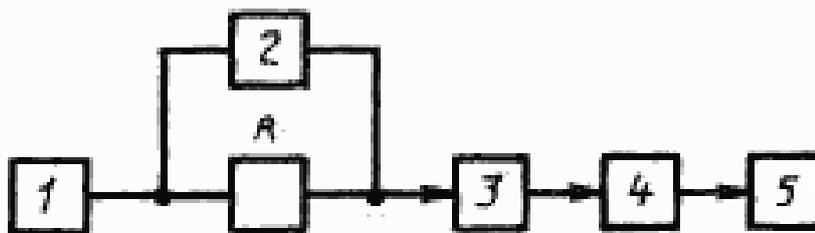
1 — генератор НЧ сигналов; 2 — вольтметр; 3 — измеряемая СЛ;
