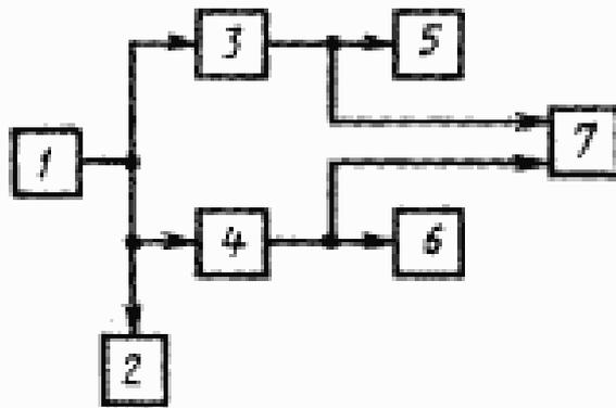
1 — низкочастотный генератор сигналов; 2 — вольтметр; 3 — канал А; 4 — канал В; 5 — номинальное сопротивление нагрузки; 6 — номинальное сопротивление нагрузки; 7 — фазометр
