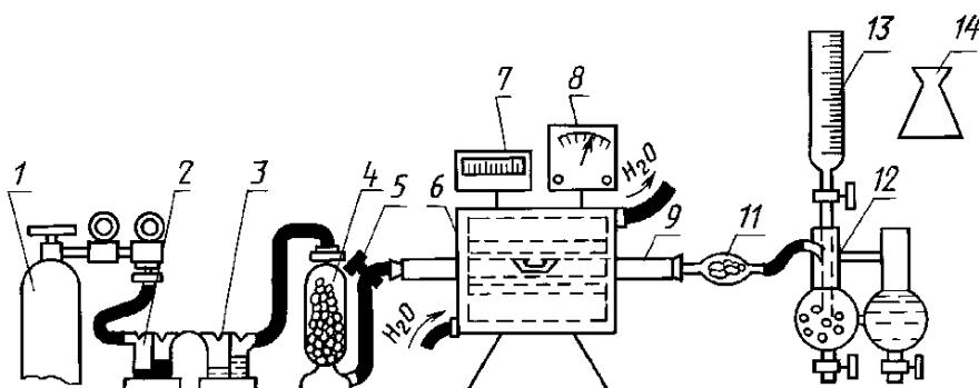
Установка для определения содержания серы состоит из следующих элементов: баллона с кислородом 1, снабженного редукционным вентилем для пуска и регулирования тока кислорода; склянки Тищенко 2, содержащей раствор марганцовокислого калия в растворе 300 г/дм<sup>3</sup> гидроокиси
