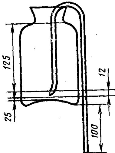
3.2. После окончания взбалтывания сосуд снимают с мешалки, вынимают пробку и тщательно смывают водой материал с пробки в сосуд. Затем смесь доливают водой до отметки сосуда 150 мм, перемешивают палочкой и дают отстояться в течение 10 мин.
