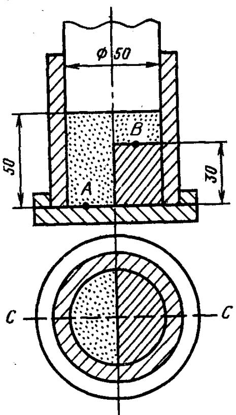
выталкиватель деревянный или металлический;
