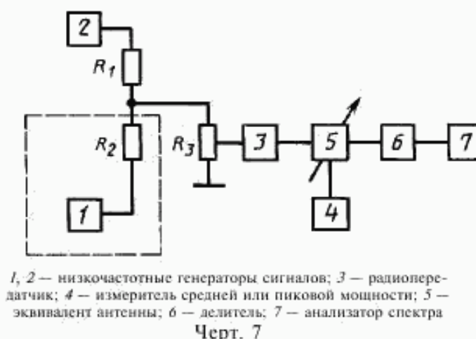
Структурная схема измерения внеполосных излучений радиопередатчиков морской подвижной службы
