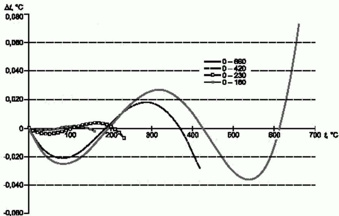
Рисунок Д.1 — Отклонение зависимости Каллендара—Ван Дюзена от стандартной функции МТШ-90
