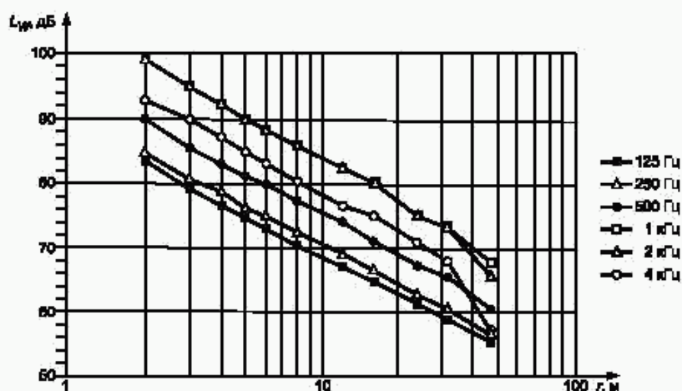
Рисунок С.2 — Экспериментальные эталонные линии в октавных полосах частот, построенные по результатам измерений при работе источника шума в свободном звуковом поле над звукоотражающей плоскостью и применяемые для коррекции линий пространственного распределения звука в рабочем помещении
