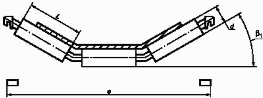
Рисунок 2 — Трехроликовая гирляндная опора
