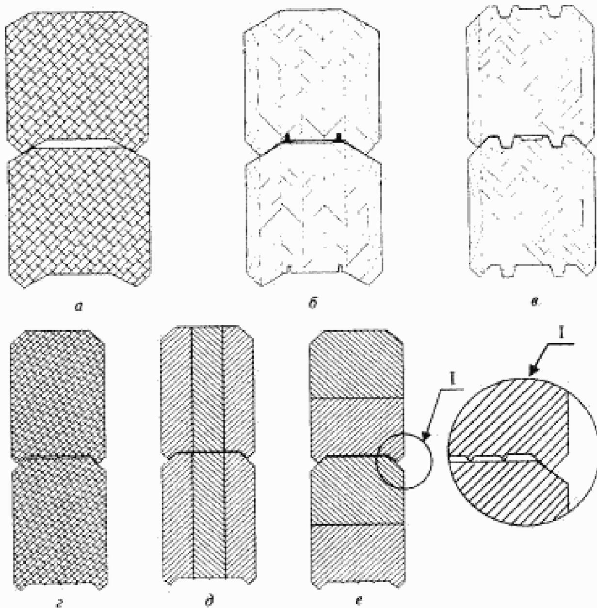
*а* — трапецидальный венцовый паз; *б* — трапецидальный венцовый паз с канавкой для уплотнителя; *в* — соединение «шпунт-гребень» с пазом для плоского уплотнителя; *г* — трапецидальный венцовый паз с уплотнителем в виде сминаемых треугольных гребней древесины; *д, е* — то же, для клееных брусьев
