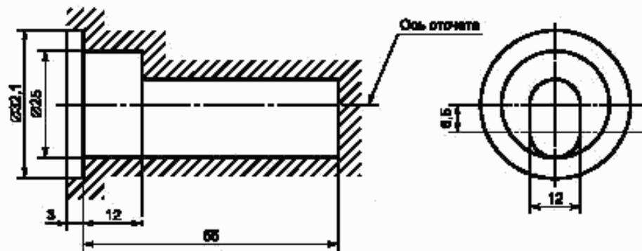
Рисунок 1.4 — Максимальный внешний контур лампы<sup>2)</sup>
