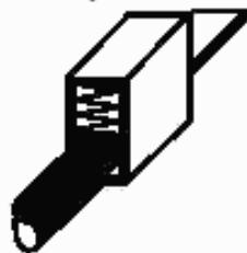
Рисунок F.6 — Примеры безвинтовых контактных зажимов
