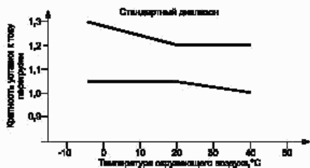
Рисунок 7 — Зависимости пределов кратности уставок тока от температуры окружающего воздуха для компенсированных реле перегрузки с выдержкой времени (см. 7.2.1.5.1)
