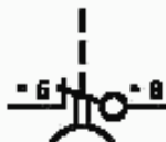
Размыкающий контакт с замедлением при замыкании
