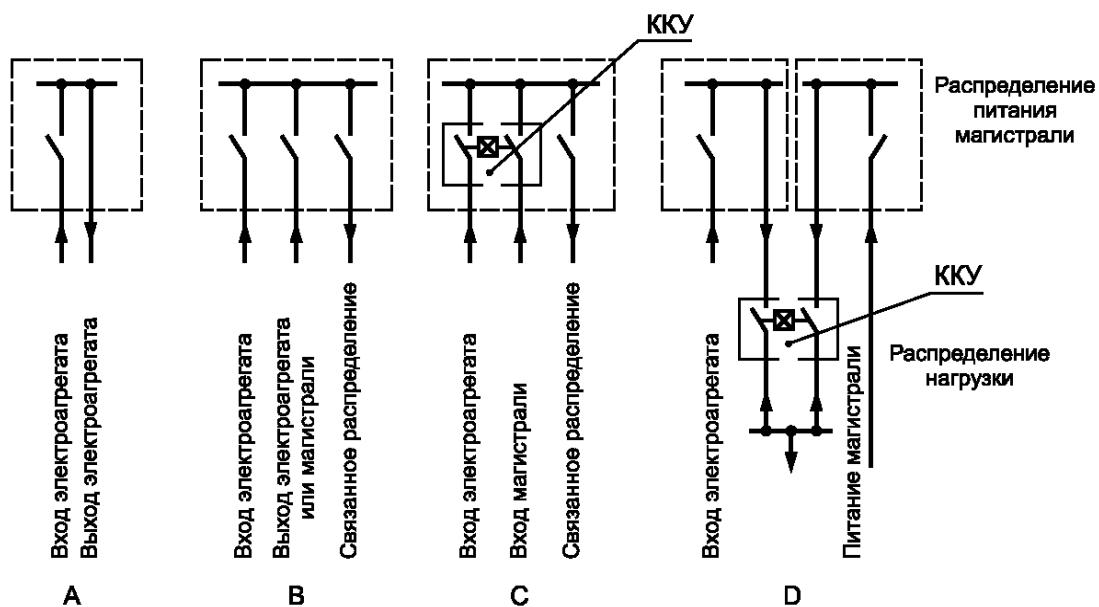
А — коммутационное устройство одиночного электроагрегата;
