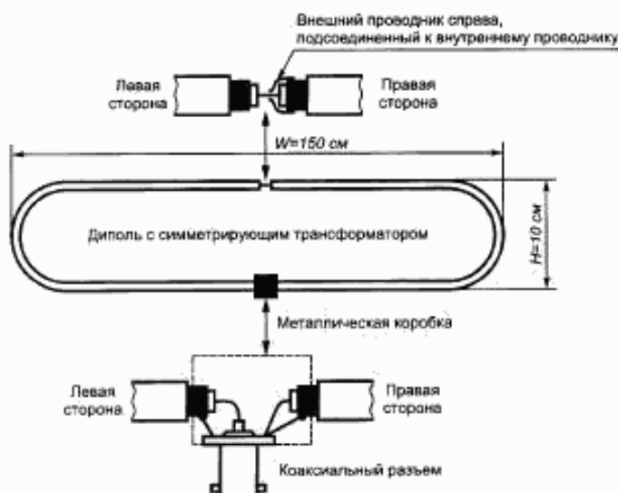
Рисунок Д.3 — Конструкция калибровочного диполя
