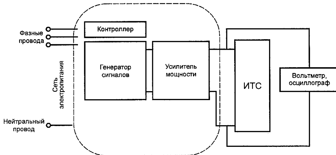
Рисунок 3 — Схема испытательного оборудования с усилителем мощности
