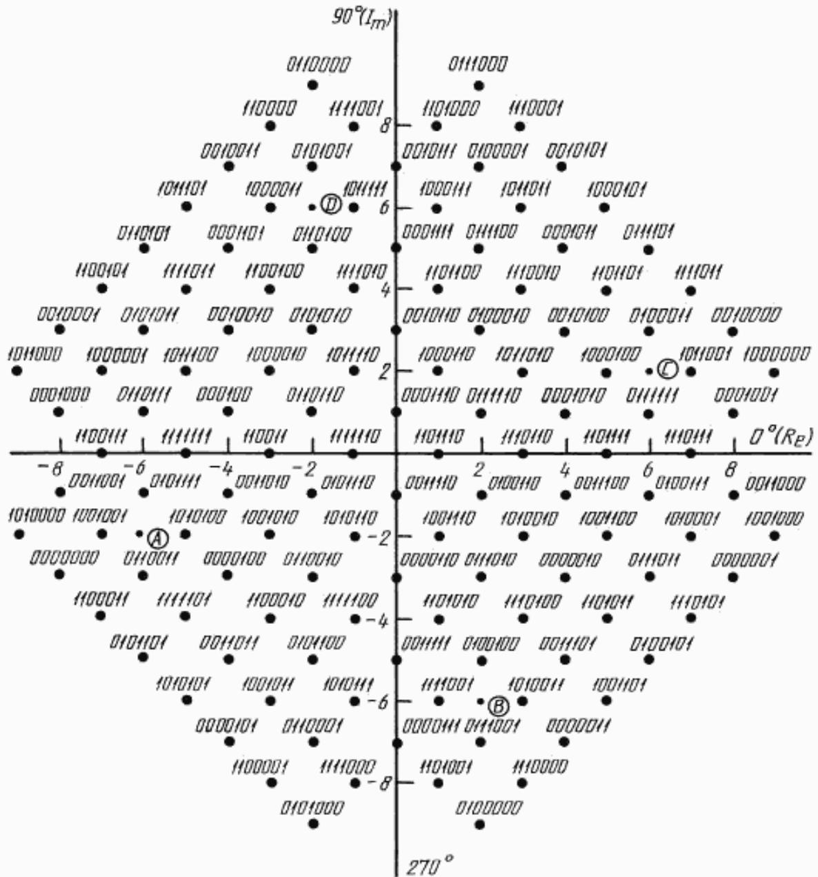
Двоичные числа относятся к  $Y_{0n}, Y_{1n}, Y_{2n}, Q_{3n}, Q_{4n}, Q_{5n}$  и  $Q_{6n}$ . А, В, С, D относятся к элементам синхронизирующего сигнала.
