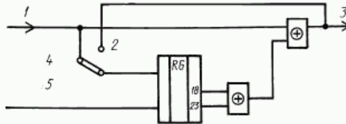
1 — вход данных; 2 — скремблер; 3 — выход данных; 4 — дескремблер; 5 — синхронизация элементов передаваемых (принимаемых) данных
