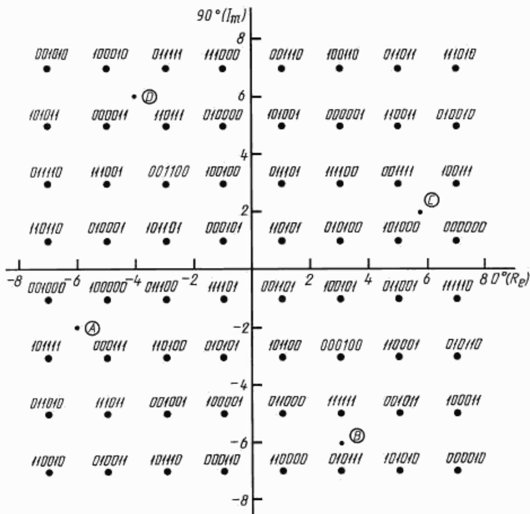
Двоичные числа относятся к  $Y_{0n}, Y_{1n}, Y_{2n}, Q_{3n}, Q_{4n}$  и  $Q_{5n}$ . А, В, С, D относятся к элементам синхронизирующего сигнала.
