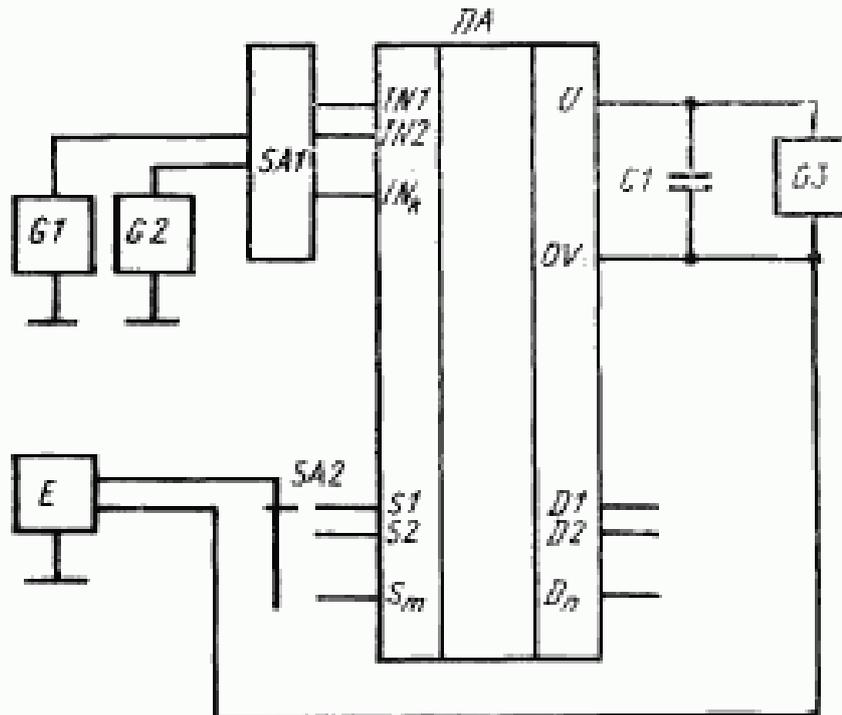
*DA* — измеряемая микросхема;  $S1, S2, \dots, S_m$  — аналоговые входы;  $D1, D2, \dots, D_n$  — аналоговые выходы;  $U$  — вывод питания;  $IN1, IN2, \dots, IN_k$  — управляющие входы;  $OY$  — общий вывод;  $G1-G3$  — источники постоянного напряжения;  $SA1$  — коммутационное устройство, обеспечивающее подключение источников постоянного напряжения  $G1, G2$  к управляющим входам  $IN1, IN2, \dots, IN_k$ ;  $SA2$  — переключатель;  $C1$  — конденсатор;  $E$  — измерительный мост
