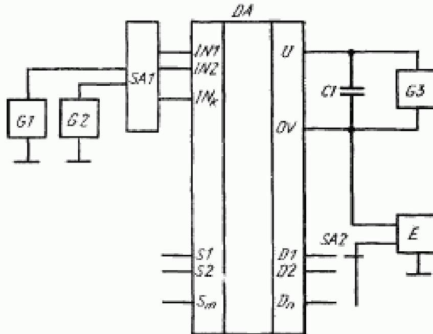
*DA* — измеряемая микросхема; *S1, S2, ..., Sm* — аналоговые входы; *D1, D2, ..., Dn* — аналоговые выходы; *U* — вывод питания; *IN1, IN2, ..., INn* — управляющие входы; *OV* — общий вывод; *G1—G3* — источники постоянного напряжения; *SA1* — коммутационное устройство, обеспечивающее подключение источников постоянного напряжения *G1, G2* к управляющим входам *IN1, IN2, ..., INn*; *SA2* — переключатель; *C1* — конденсатор; *E* — измерительный мост
