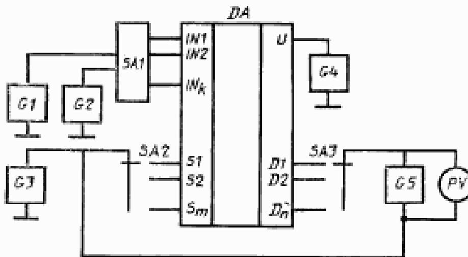
DA — измеряемая микросхема;  $S_1, S_2, \dots, S_m$  — аналоговые входы;  $D_1, D_2, \dots, D_n$  — аналоговые выходы;  $IN_1, IN_2, \dots, IN_k$  — управляющие входы;  $U$  — вывод питания;  $G_1-G_4$  — источники постоянного напряжения;  $G_5$  — источник постоянного тока;  $SA_1, SA_3$  — переключатели;  $SA_1$  — коммутационное устройство, обеспечивающее подключение  $IN_1, IN_2, \dots, IN_k$  к  $G_1, G_2$ ;  $PV$  — измеритель напряжения
