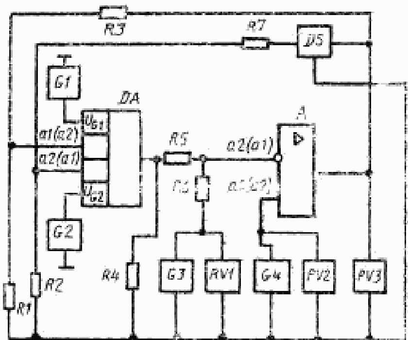
$DA$  — проверенный КН или ОУ;  $A$  — вспомогательное устройство балансировки (ВУБ);  $G1$ ,  $G2$ ,  $G3$ ,  $G4$  — источники постоянного напряжения;  $DS$  — устройство выборки и хранения;  $PV1$ ,  $PV2$ ,  $PV3$  — измерители постоянного напряжения;  $R1$ ,  $R2$ ,  $R3$ ,  $R7$  — резисторы делителей напряжения;  $R4$  — резистор нагрузки;  $R5$ ,  $R6$  — суммирующие резисторы;  $a1$  — инвертирующий вход;  $a2$  — неинвертирующий вход.
