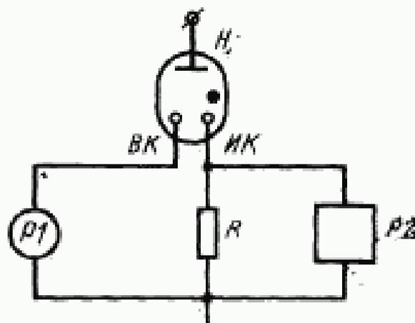
$R$  — измерительный резистор;  $P1$  — измеритель постоянного тока;  $P2$  — осциллограф или импульсный вольтметр;  $H$  — испытываемый индикатор;  $BK$  — вспомогательный катод;  $IK$  — индикаторный анод
