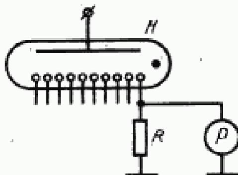
$R$  — резистор;  $P$  — измеритель напряжения;  $H$  — испытуемый индикатор
