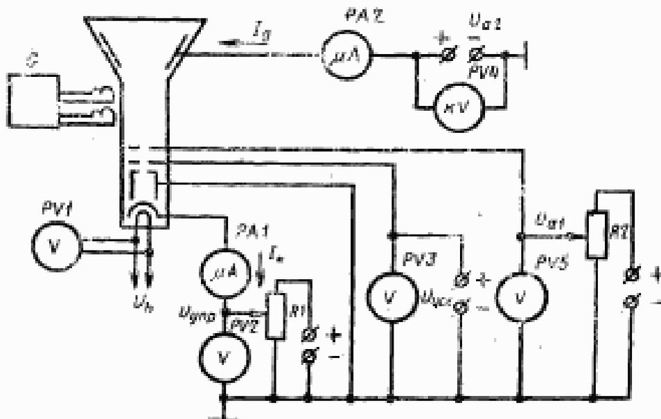
$U_{a1}$ —источник напряжения первого анода (фокусирующего электрода);  $U_{a2}$ —источник напряжения второго анода;  $U_{уск}$ —источник напряжения ускоряющего электрода;  $U_{упр}$ —источник напряжения управляющего электрода (катода);  $U_n$ —источник напряжения накала;  $G$ —генератор развертывающих токов;  $PA1$ ,  $PA2$ —микроамперметры;  $PV1$ — $PV5$ —вольтметры (киловольтметры);  $R1$ ,  $R2$ —регулирующие резисторы
