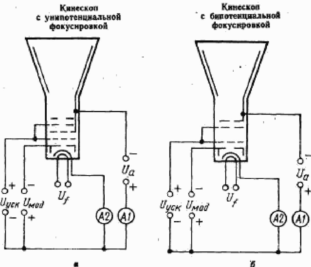
$A1$ ,  $A2$ —измерительные приборы постоянного тока;  $U_f$ —напряжение накала (постоянное и переменное);  $U_{mod}$ —постоянное напряжение модулятора;  $U_{уск}$ —постоянное напряжение ускоряющего электрода и соединенных с ним электродов;  $U_a$ —постоянное напряжение анода.
