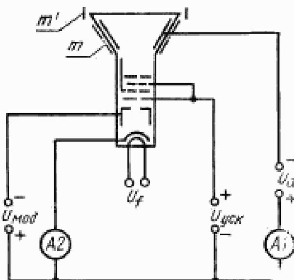
$A1$ ,  $A2$  — измерительные приборы постоянного тока;  $U_f$  — напряжение накала (постоянное или переменное);  $U_{мод}$  — постоянное напряжение модулятора;  $U_{уск}$  — постоянное напряжение ускоряющего электрода и соединенных с ним электродов;  $U_a$  — постоянное напряжение анода;  $m'$  — внешнее проводящее покрытие кинескопа;  $m$  — металлическое взрывозащитное устройство.
