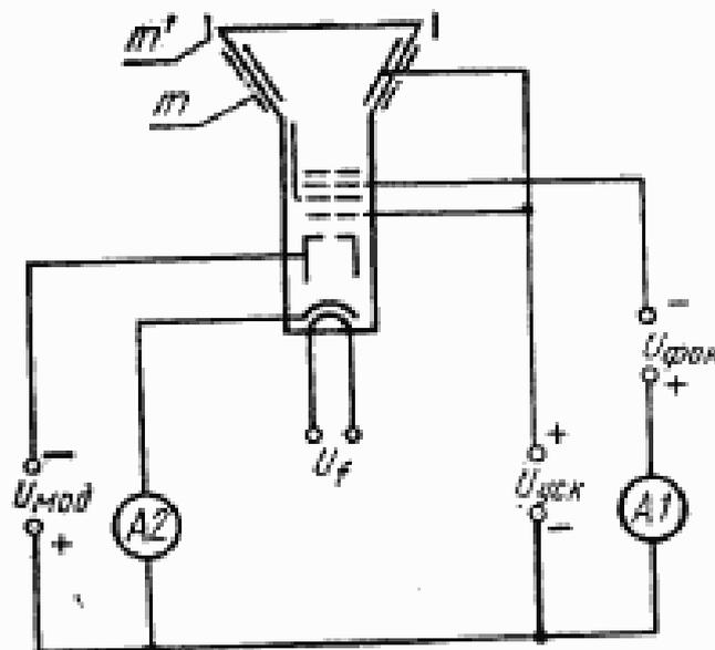
$A1, A2$  — измерительные приборы постоянного тока;  $U_f$  — напряжение накала (постоянное и переменное);  $U_{mod}$  — постоянное напряжение модулятора;  $U_{уск}$  — постоянное напряжение ускоряющего электрода и соединенных с ним электродов;  $U_{фок}$  — постоянное напряжение фокусирующего электрода;  $m$  — внешнее проводящее покрытие кинескопа;  $m'$  — металлическое взрывозащитное устройство.
