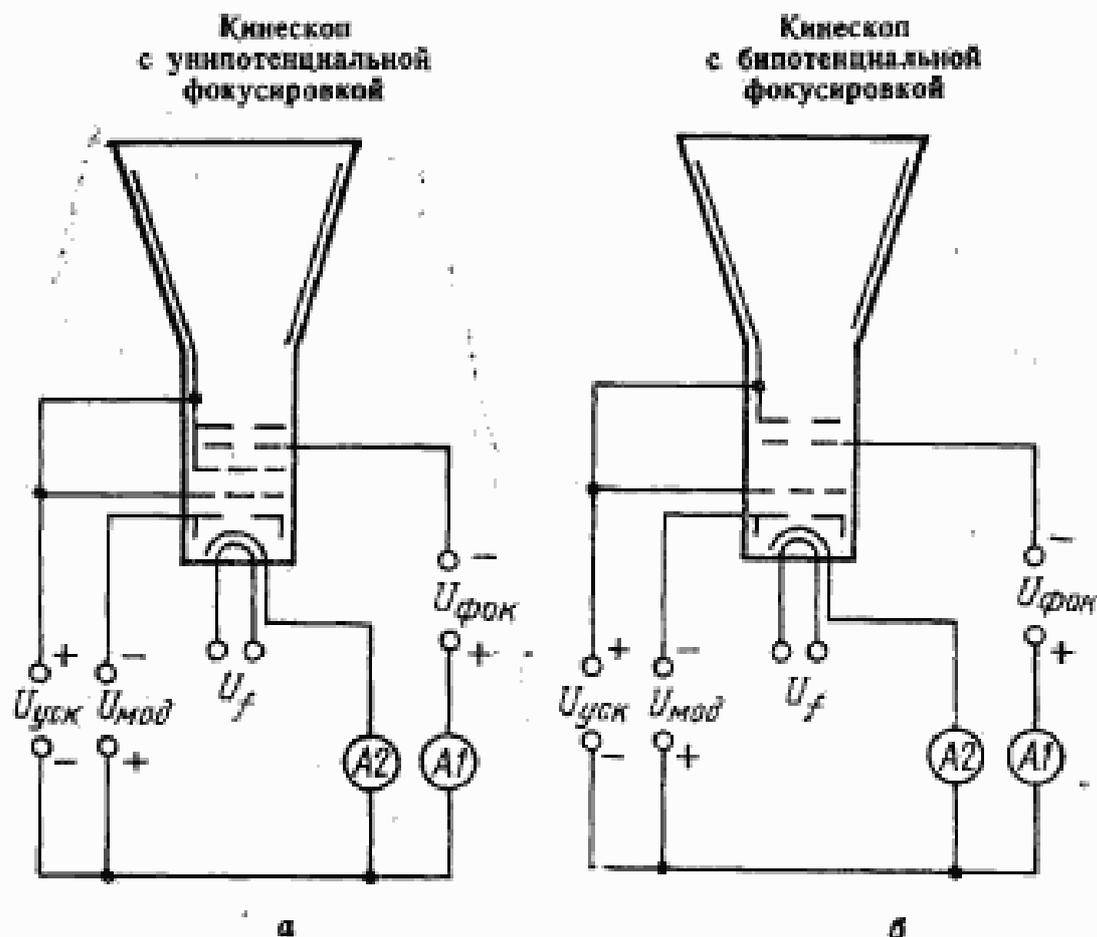
$A1, A2$ —измерительные приборы постоянного тока;  $U_f$ —напряжение явкала (постоянное и переменное);  $U_{мод}$ —постоянное напряжение модулятора;  $U_{уск}$ —постоянное напряжение ускоряющего электрода и соединенных с ним электродов;  $U_{фок}$ —постоянное напряжение фокусирующего электрода
