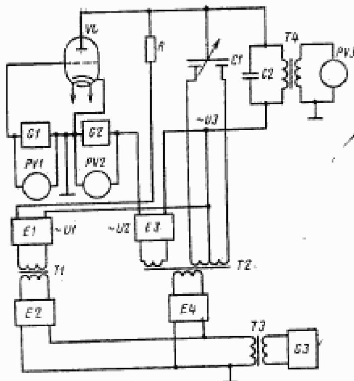
*E1, E3*—аттенюаторы; *E2*—делитель напряжения; *E4*—трехдекадный аттенюатор; *G1, G2*—источники постоянного напряжения; *G3*—генератор синусоидального напряжения; *VL*—испытуемая лампа; *PV1, PV2*—вольтметры; *PV3*—милливольтметр; *T1, T2, T3, T4*—трансформаторы; *R*—безындукционный резистор; *C1*—дифференциальный конденсатор; *C2*—конденсатор
