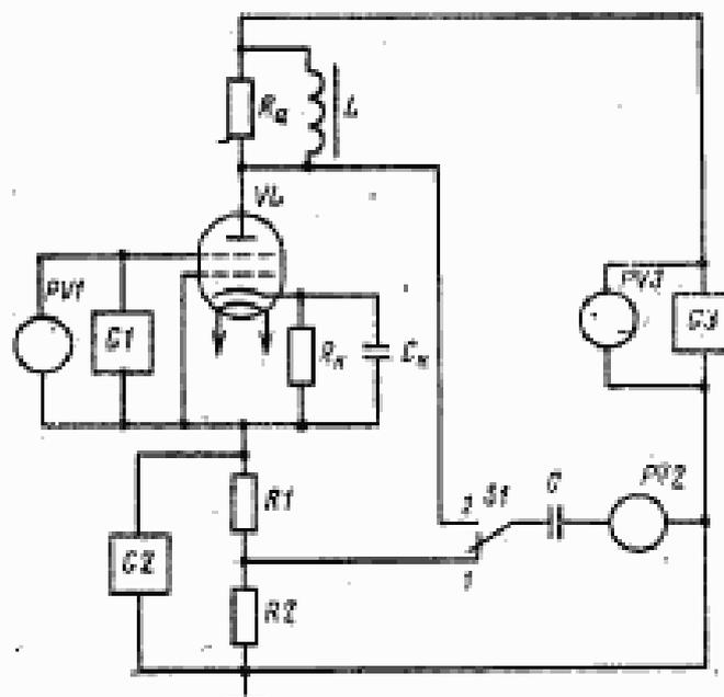
*PV1, PV3*—вольтметры постоянного тока; *PV2*—милливольтметр; *G1, G3*—источники постоянного напряжения; *G2*—генератор синусоидального напряжения; *R1, R2, Rk*—измерительные резисторы; *Rk*—катодный резистор; *C*—разделительный конденсатор; *VL*—испытываемая лампа; *S1*—переключатель; *L*—дрессель
