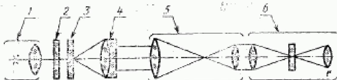
1 — осветитель; 2 — рассеивающая пластина; 3 — тест-объект; 4 — объектив коллиматора; 5 — испытуемый прибор; 6 — диоптрийная трубка
