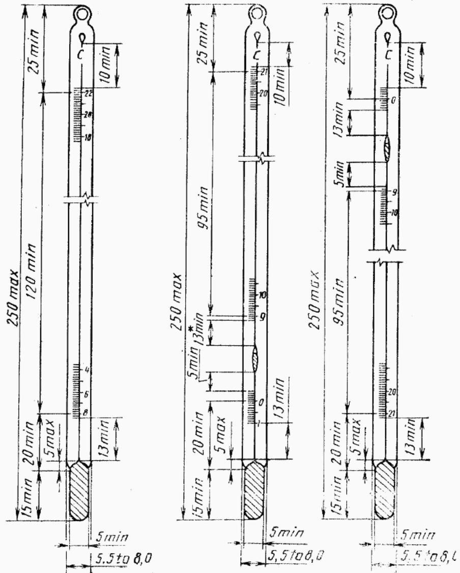
\* Размер для термометров STC/0,5/245/305, STC/1/190/310 и STC/1/290/410 равен 30 мм.
