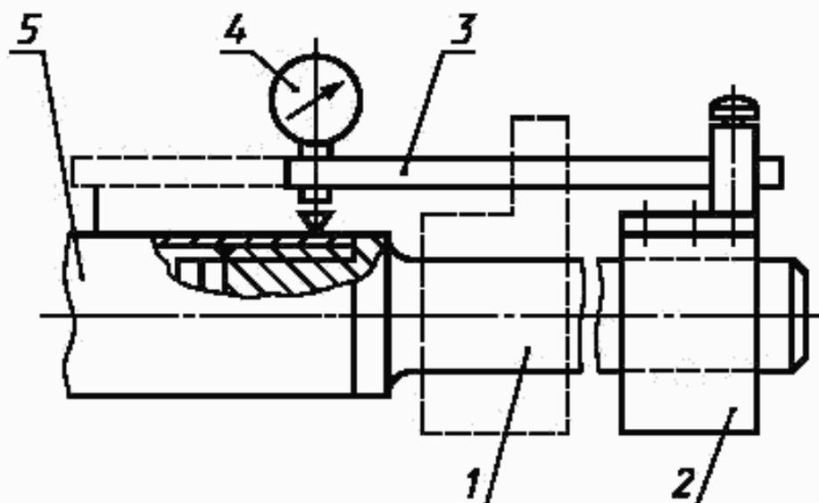
1 — оправка; 2 — втулка; 3 — державка; 4 — индикаторная головка; 5 — труба
