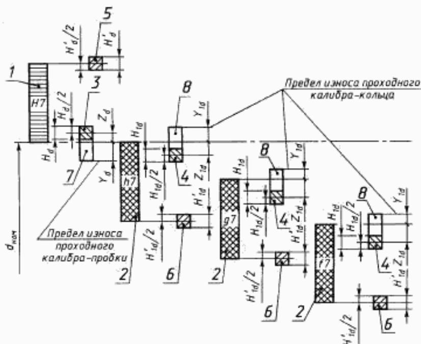
1 — поле допуска центрирующего диаметра  $d$  втулки; 2 — поле допуска центрирующего диаметра  $d$  вала; 3 — поле допуска на изготовление проходного калибра-пробки; 4 — поле допуска на изготовление проходного калибра-кольца; 5 — поле допуска на изготовление непроходного калибра-пробки;  $H'_d$  — величина допуска; 6 — поле допуска на изготовление непроходного калибра-кольца,  $H'_{1d}$  — величина допуска; 7 — поле износа калибра-пробки; 8 — поле износа калибра-кольца
