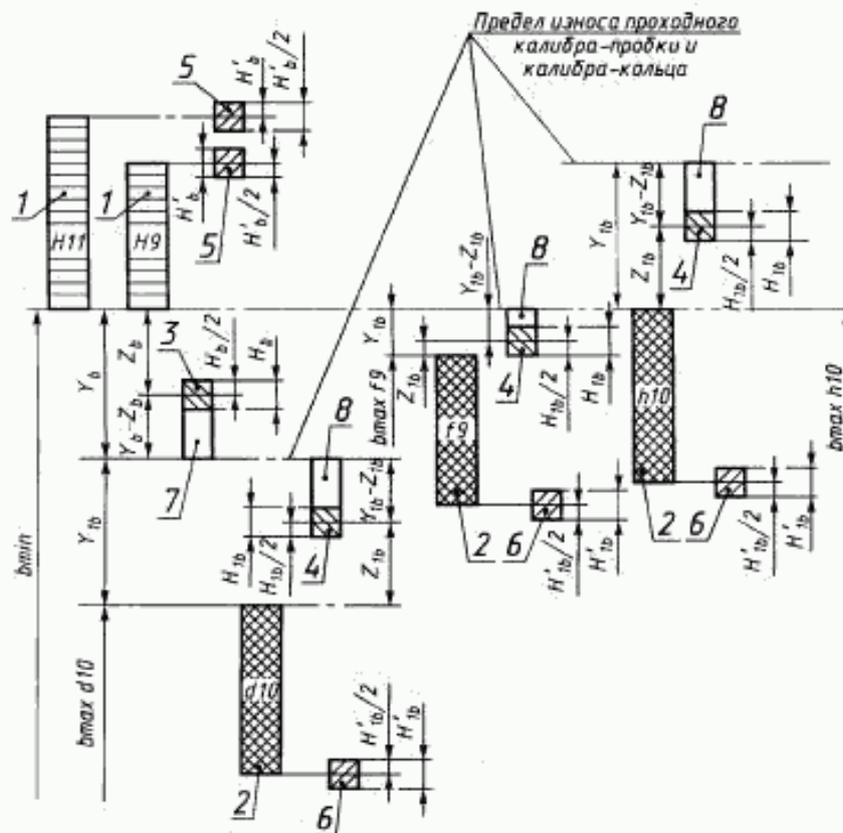
1 — поле допуски ширины паза  $b$  ступки; 2 — поле допуска толщины зуба  $b$  вали; 3 — поле допуска на изготовление проходного калибра-пробки; 4 — поле допуска на изготовление проходного калибра-кольца; 5 — поле допуска на изготовление непроходного калибра-пробки;  $H'_b$  — величина допуска;  $\delta$  — поле допуска на изготовление непроходного калибра-кольца,  $H'_{1b}$  — величина допуска; 7 — поле износа калибра-пробки; 8 — поле износа калибра-кольца
