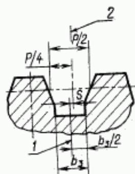
Положение оси симметрии канавки: 1 — действительное, 2 — номинальное.
