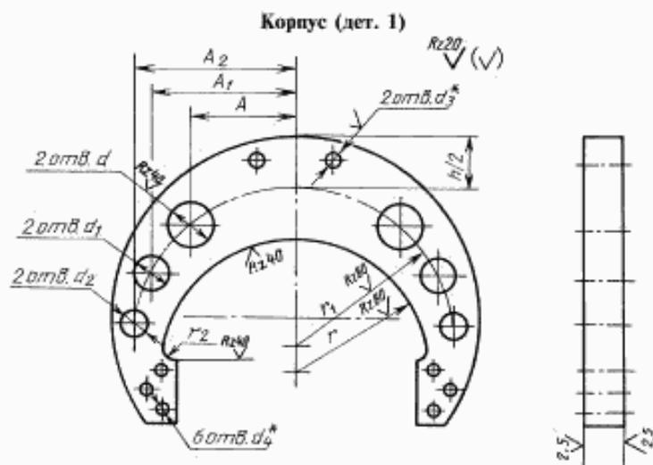
\* Отверстия  $d_3$  — по сопрягаемой дет. 5; отверстия  $d_4$  — по сопрягаемой дет. 2 и 3.
