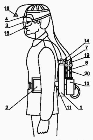
I — автономный побудитель расхода воздуха; 2 — аккумулятор; 3 — очки; 4, 16 — заборный штуцер; 7, 19 — поглотителя; 8, 20 — ротаметры; 10 — очиститель воздуха; 11 — крепежный гарнитур; 14 — регулировочный пентиль; 38 — пробоотборник
