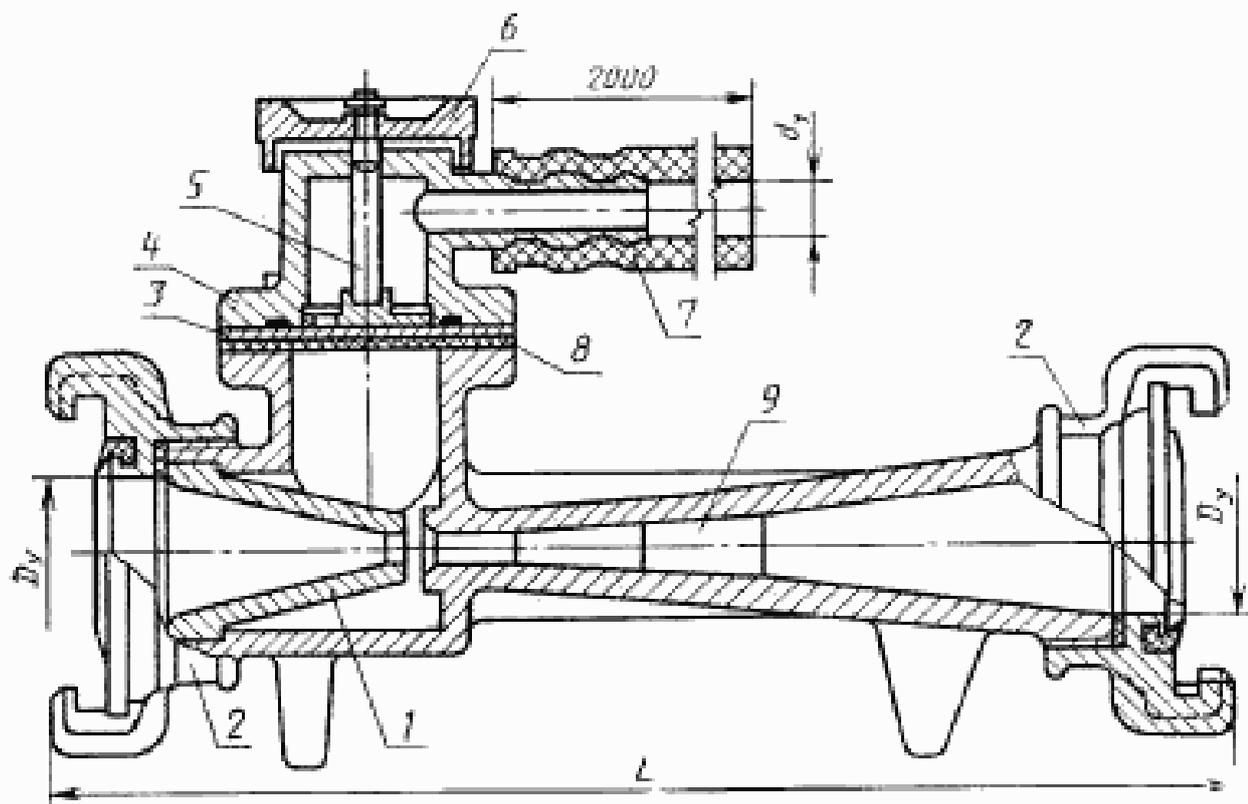
1—сопло; 2—соединительная головка; 3—дозировочная шайба; 4—корпус дозатора; 5—дозатор; 6—маховик; 7—всасывающий рукав; 8—обратный клапан; 9—диффузор
