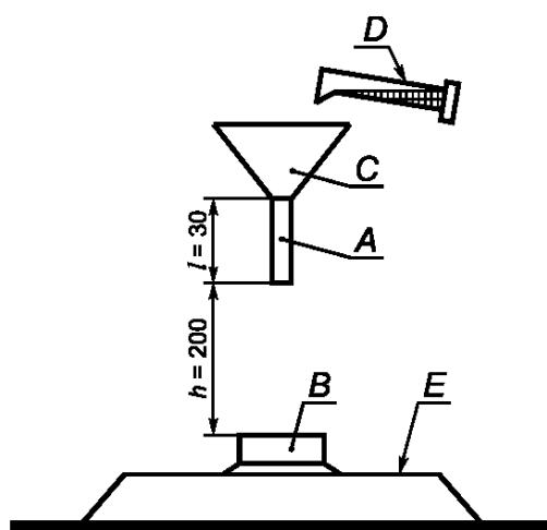
A — трубка воронки длиной  $l = 30$  мм внутренним диаметром 8 мм; B — прибор для испытания; C — воронка; D — сосуд с 30 мл соляного раствора; E — горизонтальная поверхность;  $h$  — высота расположения нижнего конца трубы воронки относительно прибора
