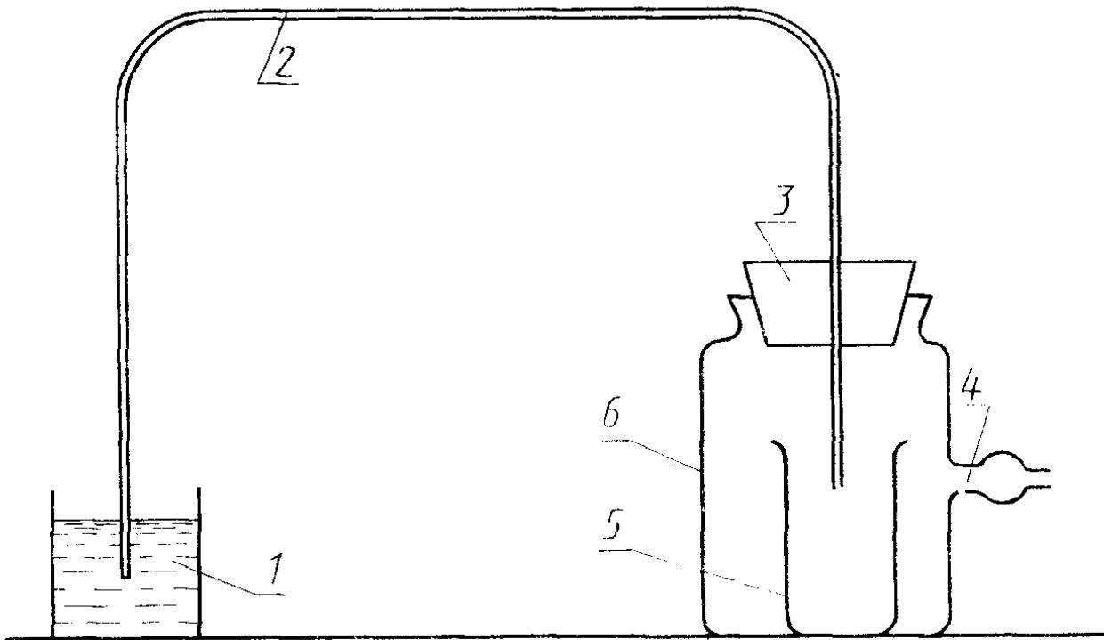
Другой конец трубки опускают в стакан 1 с растворителем.
