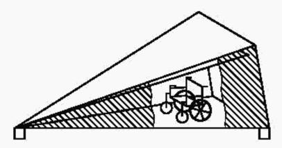
Рисунок 2 — Вертикальная поляризация в GTEM-камере
