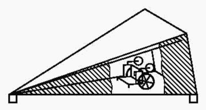
Рисунок 3 — Горизонтальная поляризация в GTEM-камере
