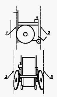
задняя вертикальная плоскость; 2 передняя вертикальная плоскость; 3 — боковая вертикальная плоскость
