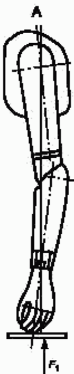
Рисунок 5 — Схема испытания на осевое нагружение концевой устройства
