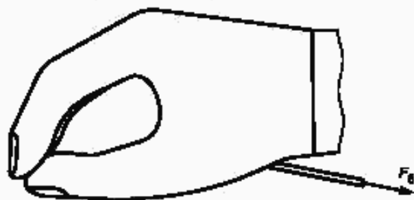
Рисунок 10 — Схема испытания механизма раскрытия пальцев кисти
