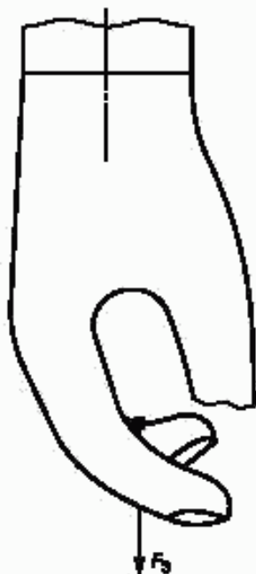
Рисунок 7 — Схема испытания фиксатора пальцев
