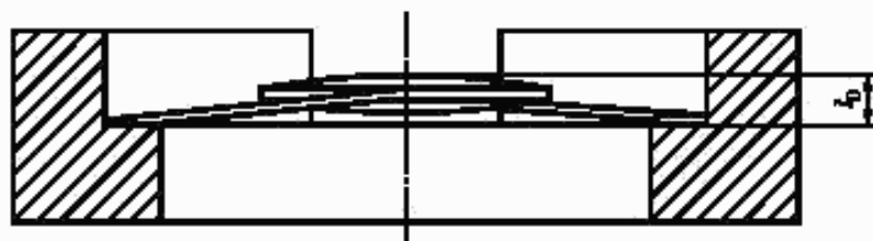
Рисунок Б.2 — Цилиндрический колодец с ИОЛ в несжатом состоянии
