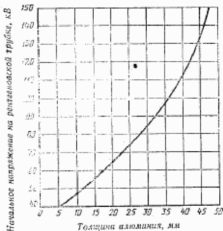
Рисунок 101 Общая фильтрация для измерения воздушной кермы
