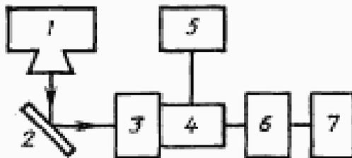
1 — источник излучения (рентгеновский аппарат); 2 — экран; 3 — монохроматор; 4 — фотоэлектронный умножитель (ФЭУ); 5 — блок питания к ФЭУ; 6 — усилитель; 7 — самопишущий регистрирующий прибор
